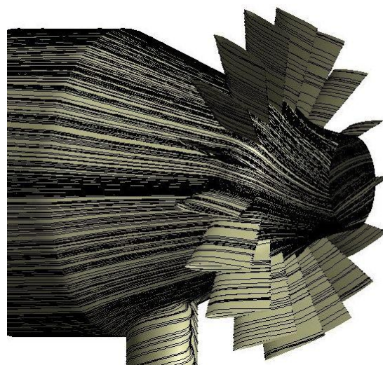
Figura 8. Linhas de cisalhamento no bulbo e distribuidor.
