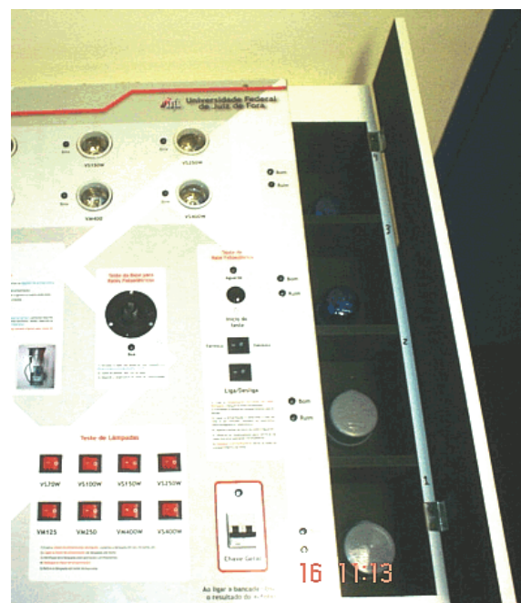
Figura 6 – Detalhe do teste de fotocélulas com o compartimento aberto.
