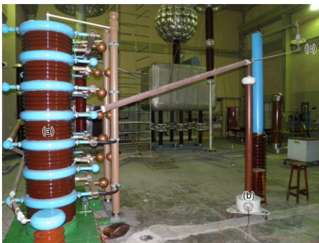
Figura 4. Montagem do ensaio: (a) GIT; (b) Divisor de tensão; (c) Amostra sob ensaio.
