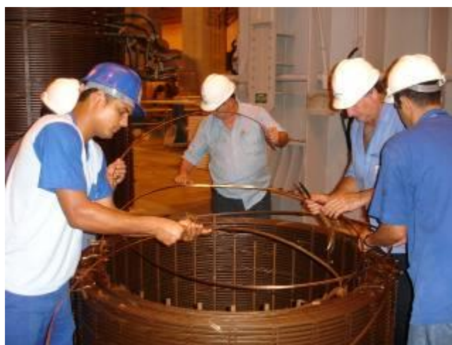
Figura 4. Análise forense do enrolamento de BT.
