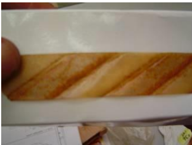
Figura 9. Papel isolante externo com depósito de enxofre.
