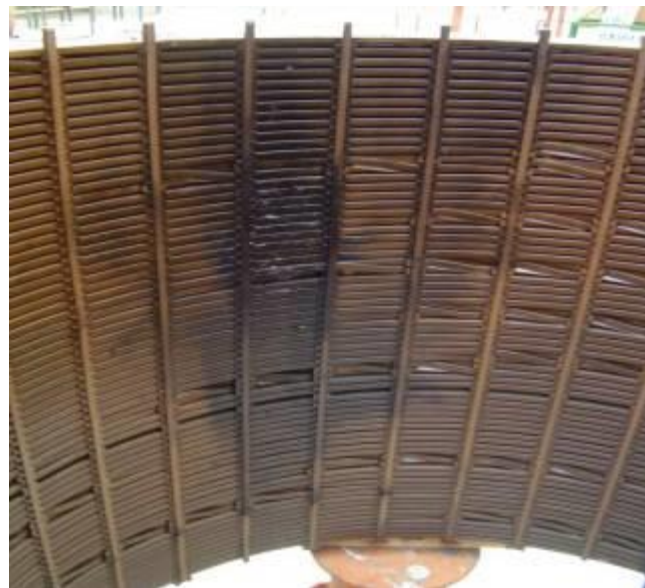
Figura 7. Face interna da bobina - Local do arco.
