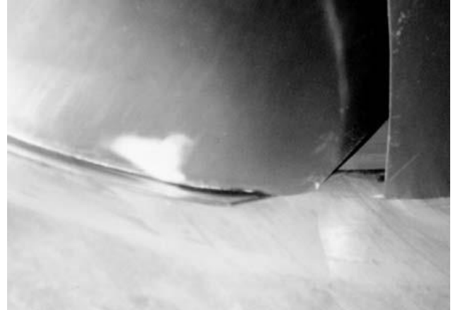
Figura 2. Cavitação na pá de uma turbina Kaplan.
