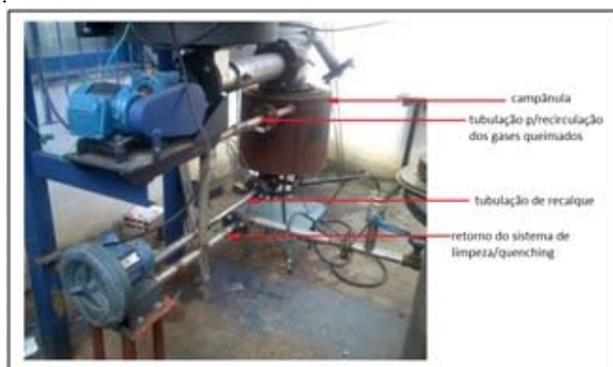
Figura 17. Nova configuração das tubulações.
