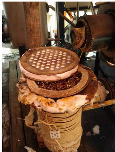
Figura 11. Limalha de aço colocada no interior da base do reator.
