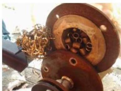
Figura 10. Material metálico inserido no aquecedor elétrico.
