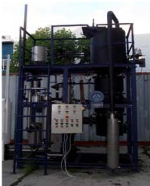
Figura 3. Gaseificador de leito fixo *downdraft* ventilado.
