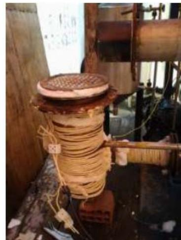
Figura 8. Redução de espessura de camada de lâ de vidro.
