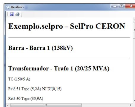
Figura 19 – Relatório da análise da seletividade de proteção obtida para o sistema.
