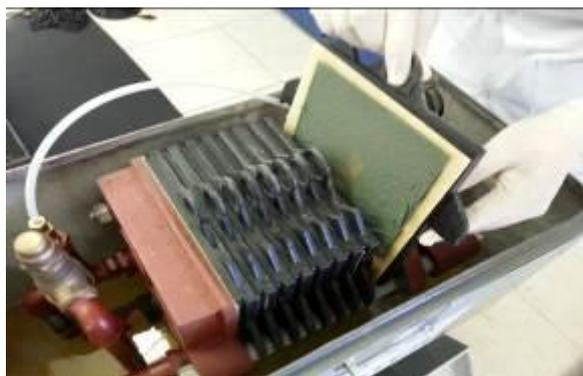
Figura 19: Retirada do papel de filtro para troca.
