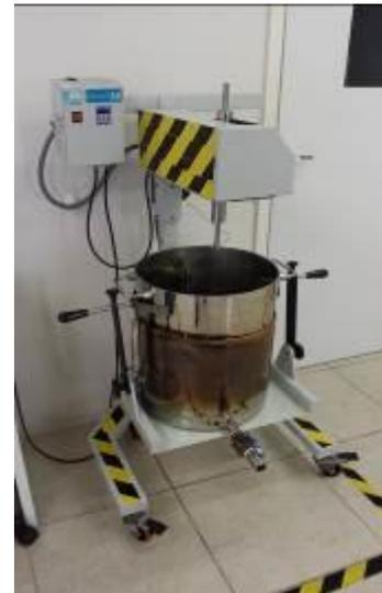
**Figura 3:** Reator de síntese e/ou preparação do óxido misto.
