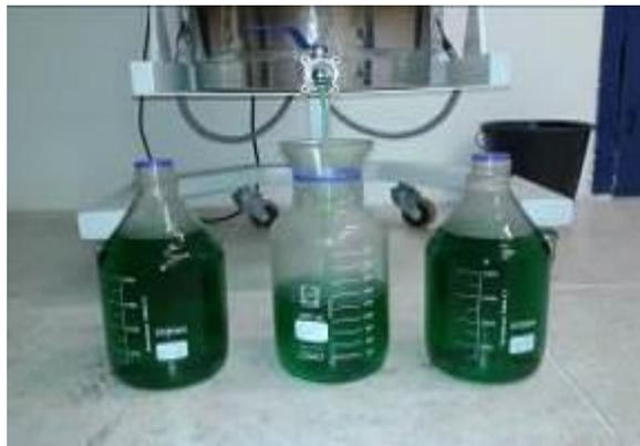
Figura 8: Oxido misto  $MgNiO_3$  (Na forma de gel) antes do tratamento térmico e calcinação.
