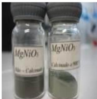
**Figura 7:** Óxido misto com tratamento térmico a 300 °C (esquerda), calcinado a 900 °C (direita).
