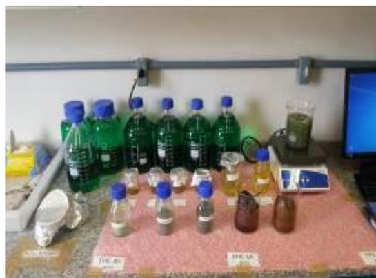
Figura 9: Oxido misto  $MgNiO_3$  (Na forma de gel), após o tratamento térmico a 300 °C e posterior calcinação a 900 °C.
