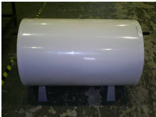
Figura 12. Reservatório pronto, após receber uma camada de espuma plástica sobre a "bolsa" térmica da Figura 10, e uma folha fina de acabamento de plástico em material PET na cor branca.
