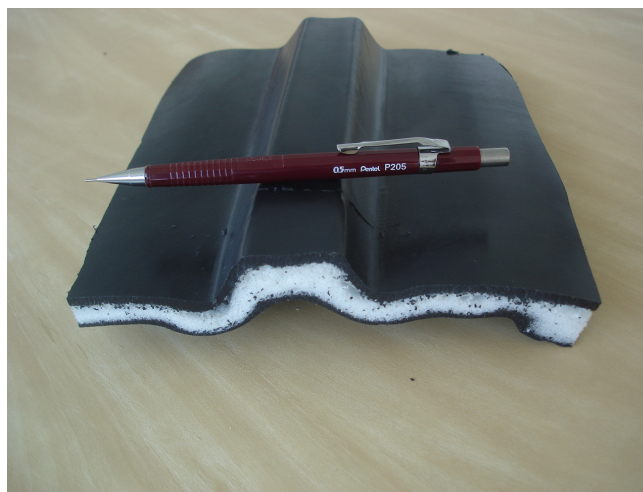
Figura 9. Nova parede em três camadas de material plástico do novo reservatório, para prover maior isolamento térmico e aumento na eficiência em conservar o calor da água de seu interior.
