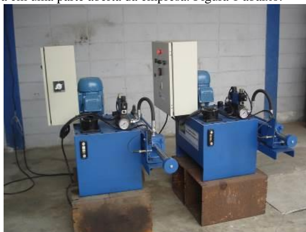
Figura 1. Cilindros no fabricante durante ensaios de experimento forçado.
