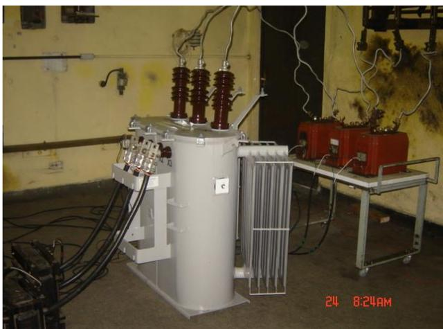
Foto 1: Protótipo tipo 1 durante ensaio CC
